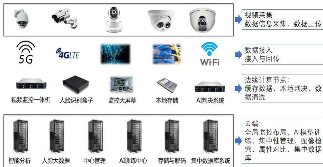
图 10 智能安防系统云边协同应用示意图
