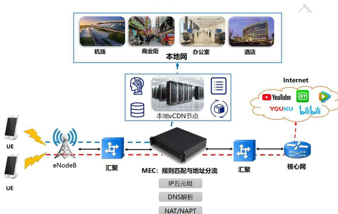
图4 基于边缘云的 vCDN 实现场景
